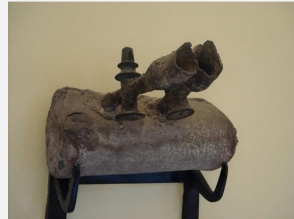
Svinčene vodovodne cevi s pipo iz obdobja Rimskega imperija
